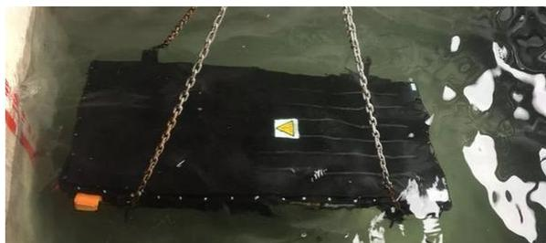
图 2-4 海水浸泡、冰水冲击测试
